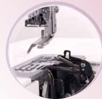
Stevige grijperkanalen met inklapbare hulpgrijper
